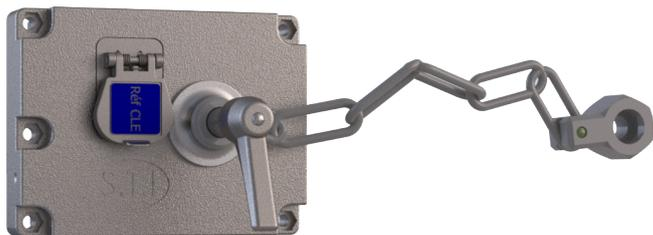
La serrure à loquet XSOL est un verrouillage d'accès à clé qui convient aux portes battantes, coulissantes et trappes. Elle est conçue en aluminium, ce qui la rend idéale pour une utilisation dans des environnements très difficiles ou corrosifs et un usage intensif.
