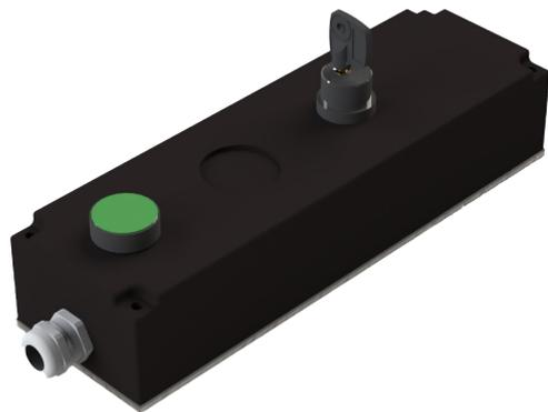
La serrure électromécanique est une serrure d'isolation pilotée électriquement. Elle peut être utilisée lorsque la libération de clé est conditionnée par un automate.
