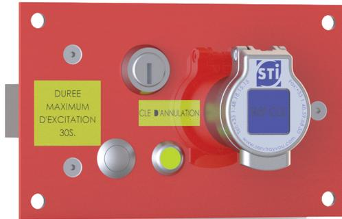
Le ERTK est un interrupteur à clé électromécanique. La libération (SP) ou l'emprisonnement (RP) de la clé sont contrôlés électriquement. Tout changement d'état de la clé est signalé par le contact lié à la serrure. Le ERTK est particulièrement adapté pour des systèmes automatisés en industrie ou les équipements ferroviaires.
